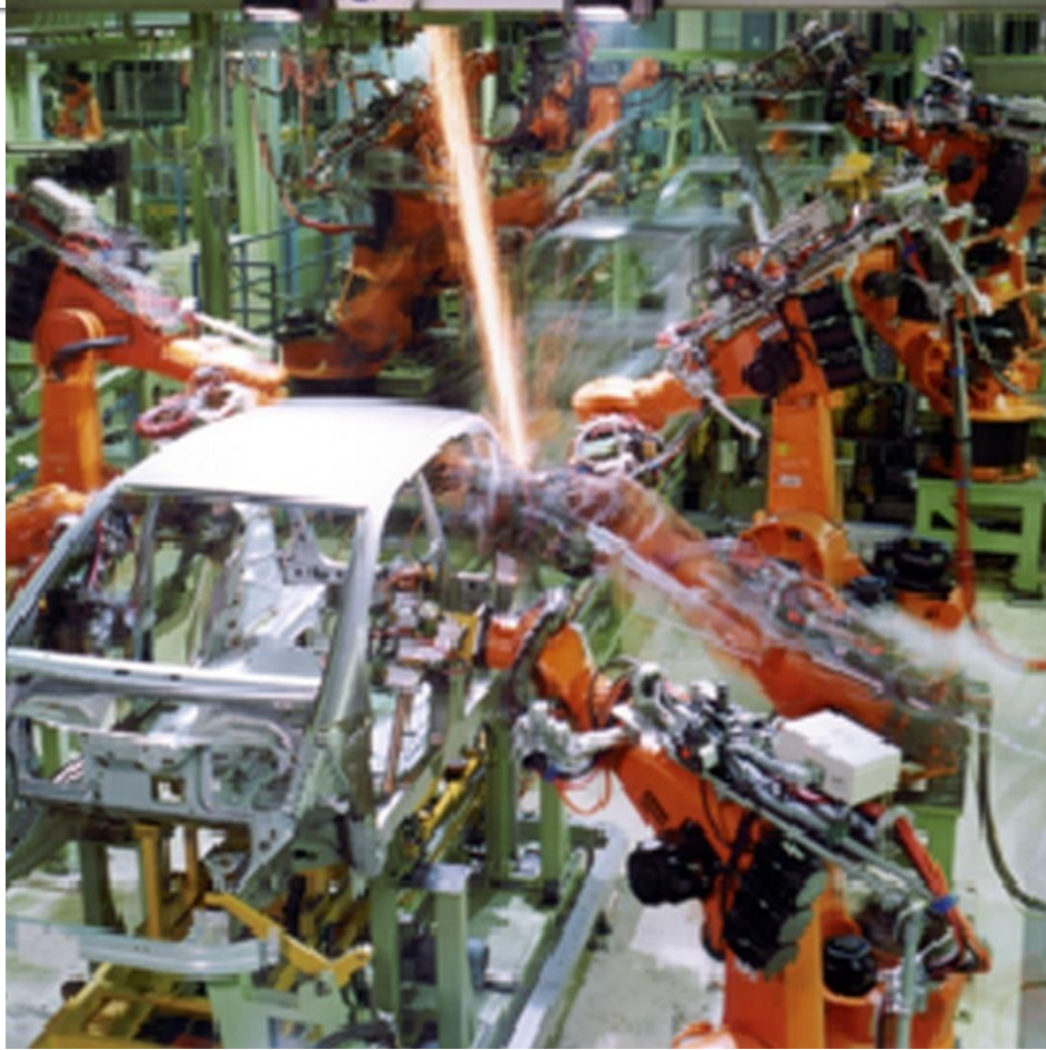
Kuka robot arms welding a Mercedes
